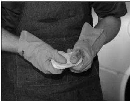
Amase la Barra de Arcilla cuando su cara llegue a estar "saturada" (al frotar la barra en la pintura, no se siente resistencia alguna).
