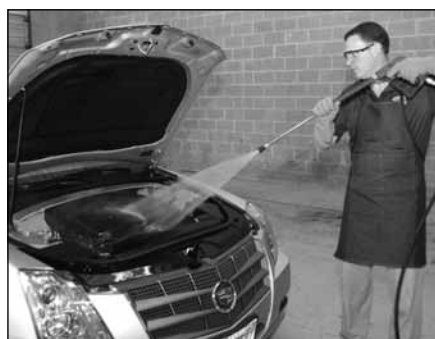
Enjuague completamente el motor, siguiendo un patrón consistente. Posiciónese a diferentes ángulos para garantizar la limpieza completa de las áreas difíciles de alcanzar. No empape los circuitos electrónicos del motor.
