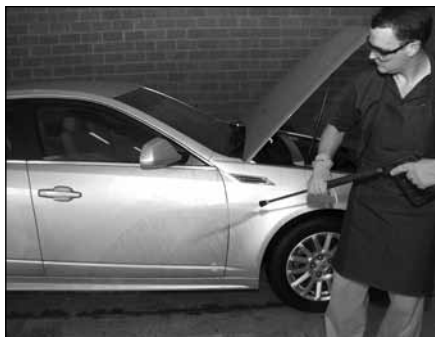
Enjuague completamente con agua a presión los paneles inferiores de la carrocería (faldones) ...
